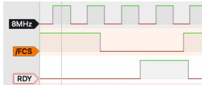
Bild 2: DMA Register Zugriff – C025913-38 ohne Modifizierung des Signals RDY
