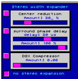
In diesem Feld befinden sich alle Funktionen, die eine Manipulation des Stereobildes erlauben. Alle drei Varianten sind monokompatibel, das heisst beim Druck auf die Monotaste des Mischpultes erscheint das Klangbild des Monosignales exakt so, als ob keine Bearbeitung stattgefunden hätte (keine Kammfiltereffekte oder Phasenauslöschungen).
