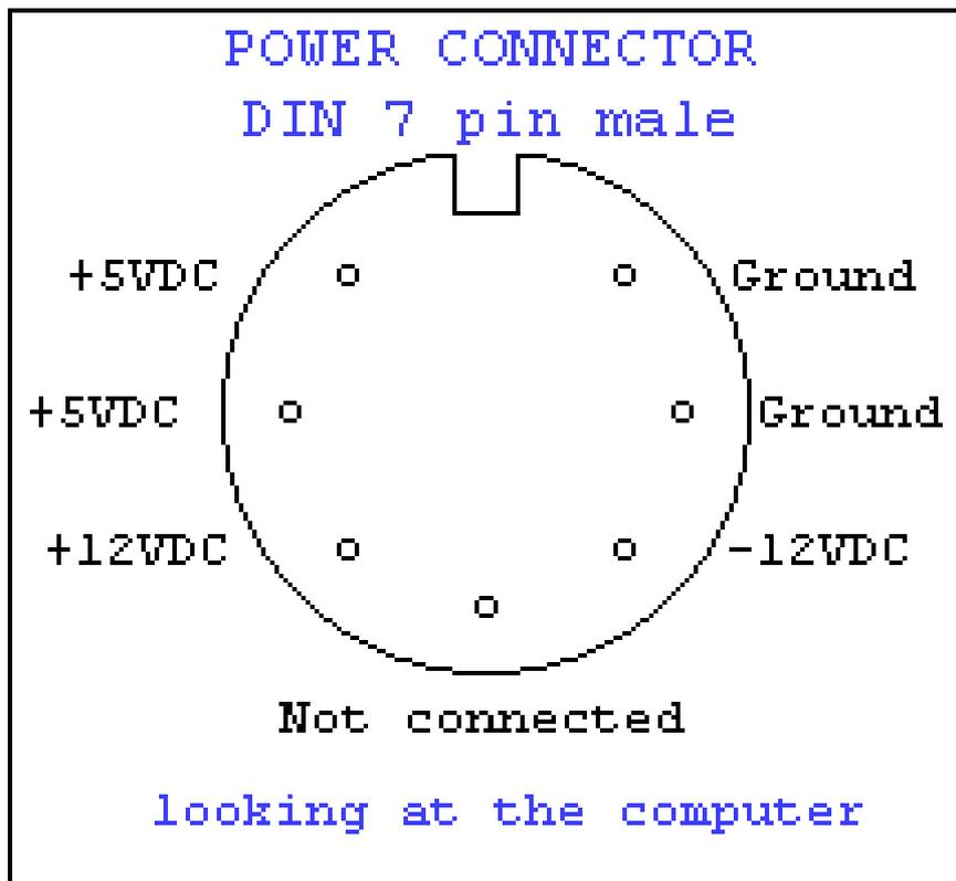
Anschluß CISCO Netzteil Modell ADP-30RB an Atari 260 / 520 ST bzw. STM
